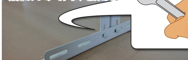
スマイルックの足にあらかじめ付けてあるネジのすぐ横の穴に付属のボルトを付けてナットで4つとも締めて完成です。
